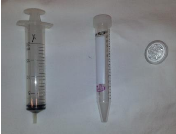
Bilde H-4 av sprøyte (NORM-JECT, 20mL), prøverør (VWR centrifuge Tube, Trace Metal free, polypropylen) og filter (VWR, European Article no. 514-0074).
