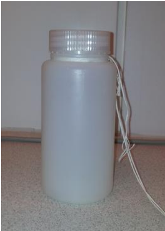
Bilde H-5 viser prøveinnsamlar som vart brukt til å ta vassprøver av Nidelva.
