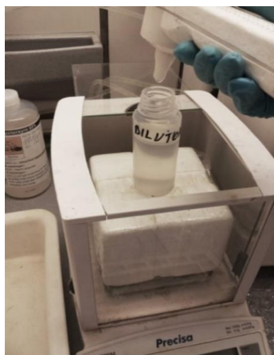
Figur 24: Fortynning av ferdig oppløst prøve ved hjelp av «pistol» med destillert vann.
