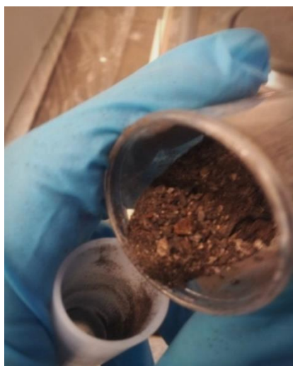
Figur 23: Overføring av prøve fra plastglass til UltraClave-rør
