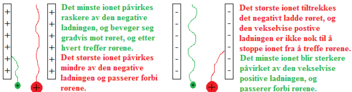
Figur 2.17: Viser de to prinsippene som brukes ved seleksjon av ioner ved MS. En positiv strøm er satt på to av rørene, der en vekselvis negativ strøm blir satt på de samme to rørene, vises til venstre i figuren. Til høyre er en negativ strøm, med vekselvis positiv strøm satt på.
