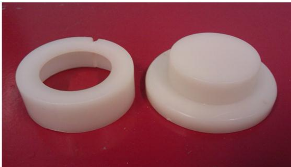
Figur 2.15: Bilde av DGT som er brukt under forsøket.
