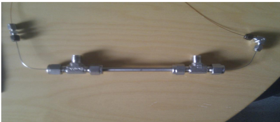
Figur 10: Membranenheten slik den er før den installeres i ovnen på gasskromatografen. På T-koblingene kobles det inn rør som frakter prøvemidiet til og fra membranenheten. Kapillærrørene tilfører bæregass (høyre rør), og transporterer prøven som er diffundert gjennom membranen til massespektrometeret (venstre rør).
