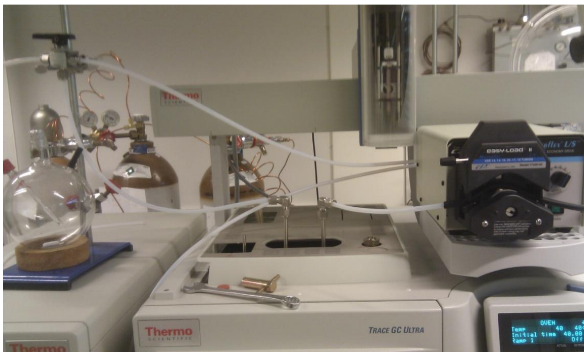
Figur 14: Oppsett for vannanalyser med prøvekolbe, toveisventil og vannpumpe.
