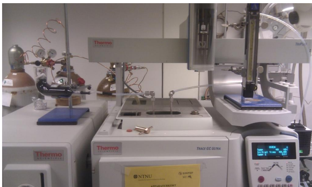
Figur 11: Oppsett for luftanalyser. Luftinntak med kullfilter til venstre, rotameter og luftpumpe til høyre.
