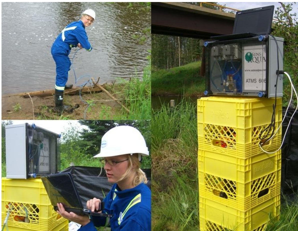
Figur 3.4: Forberedelser og ferdig oppsett for on-line måling av Zn og Fe i Christina River.
