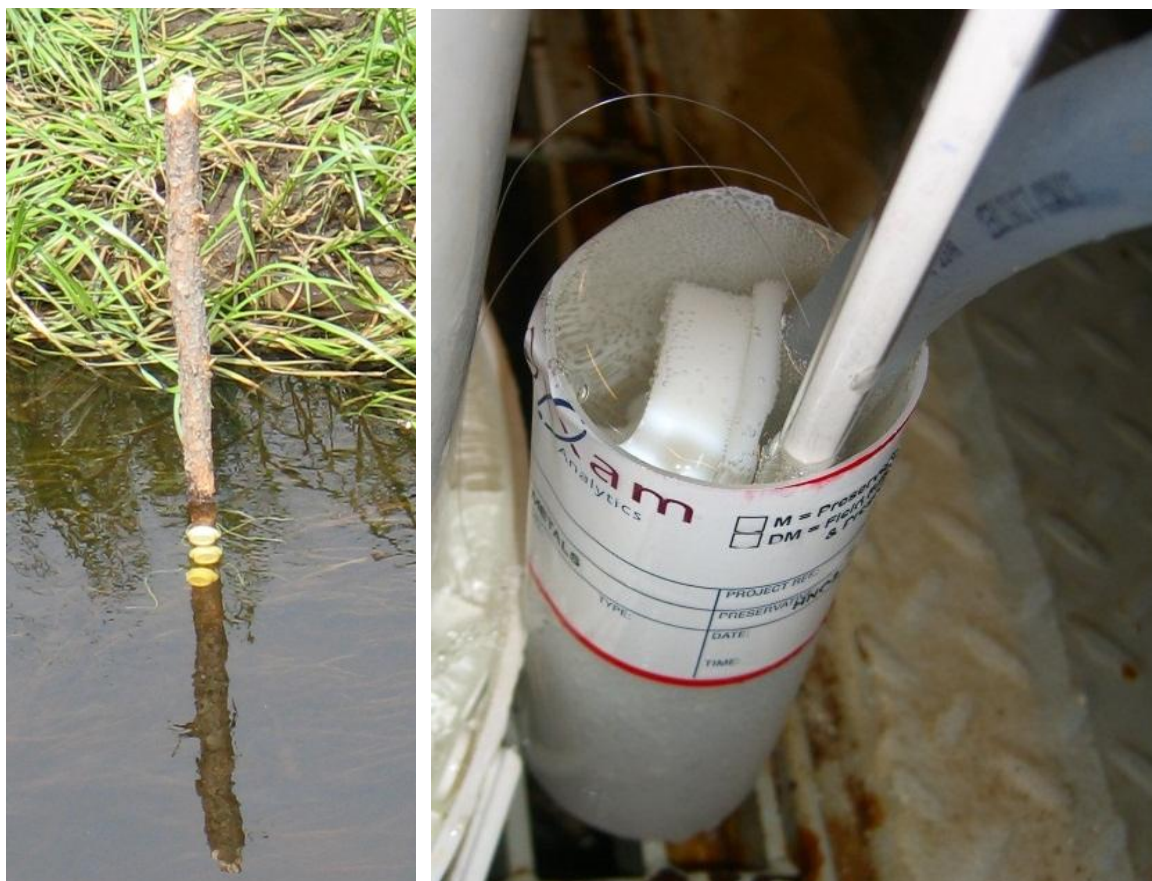
Figur 3.3: Oppsett for prøvetaking med DGT i ellevann (venstre) og råvann (høyre).
