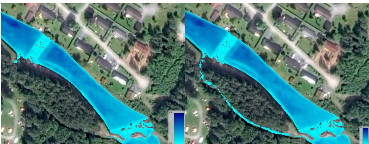
Figur 49: Utklipp av Tokkeåi som viser simulert vannføring lik 17,4 m 3 /s ved Hagusjåkanalen, hvor simulering ved bruk av kun LIDAR-data fra 2016 har ingen vannføring i kanalen (til venstre), mens ved bruk av LIDAR-data fra 2015 i området rundt terskelen sammen med 2016-
