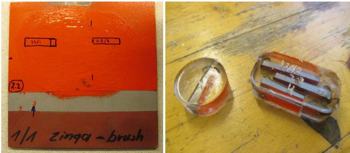
Figur 6: Markering av prøver og prøver støpt i epoksy til mikroskopering
