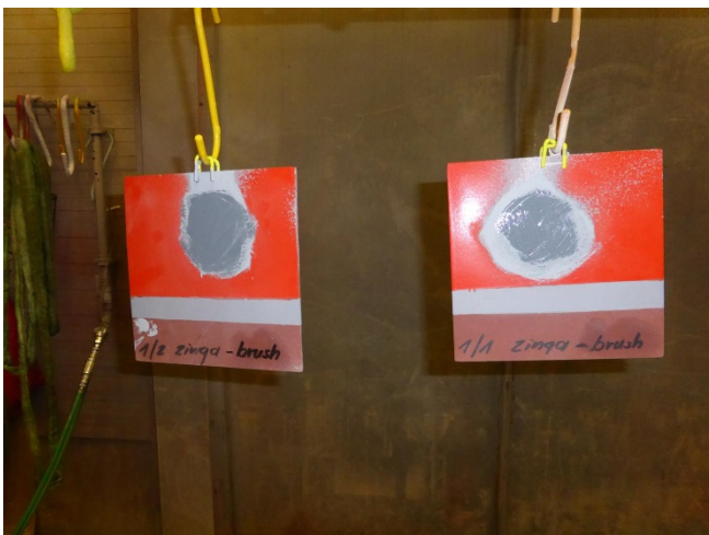
Figur 9: Prøveplater malt med sinkrik primer
