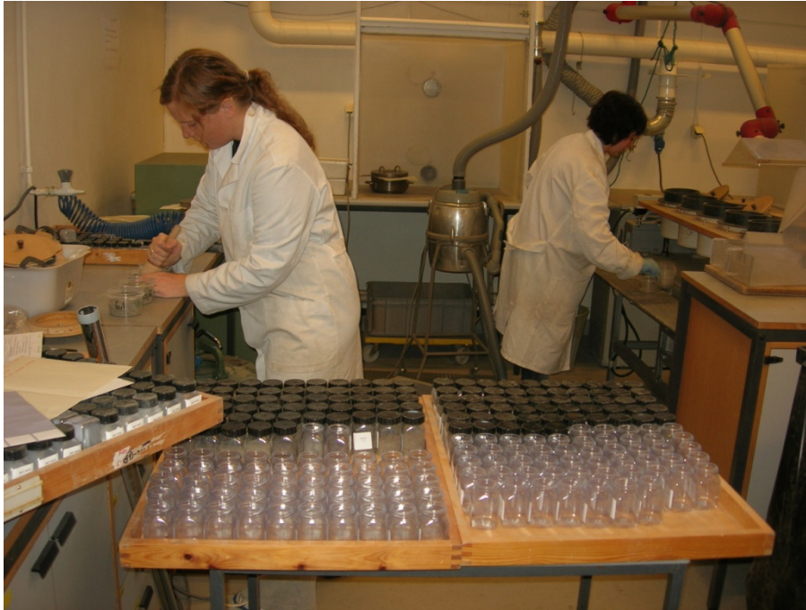
Figur 19. Knusing og sikting av jordprøver. Jordprøvene ble lagt i prøveboksene fremst i bildet.
