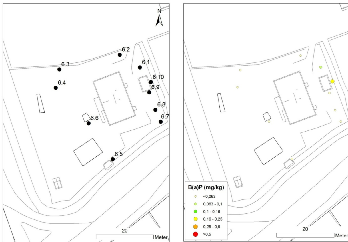
Figur 36. Oversiktskart over prøvepunktene i Singsaker barnehage til venstre. Oversiktskart over konsentrasjonsklasser for benzo(a)pyren til høyre.
