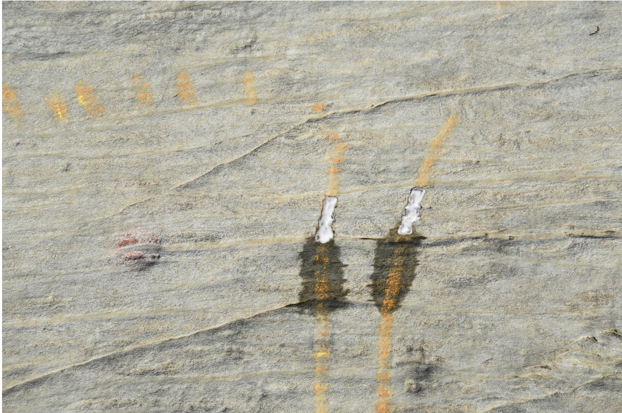
Figur 22 Frambeinet av hjortedyret (reinen) med de ulike testområde for gelene, Da 62015_20. Fuktig område er testet med Gel 2 B og Gel 2 B + EDTA (høyre side). Påført gel er Gel 2 A og Gel 2 A + EDTA (høyre side)
