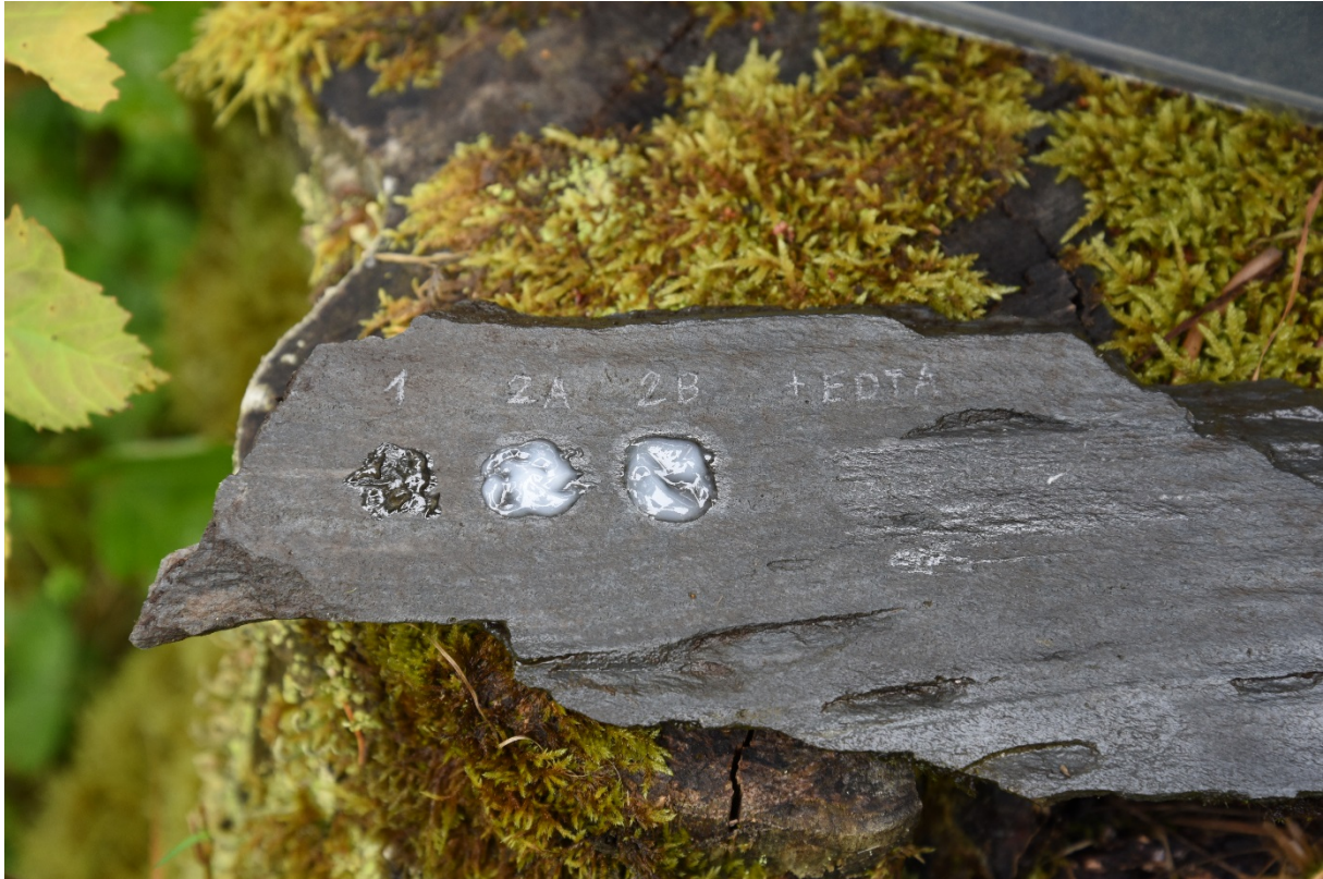
Figur 5 Gel- testene på løst steinfragment fra lokaliteten, Da 62015_06. Testene viser de tre gelene med EDTA. Steinen er tatt inn på konserveringslaben av NTNU Vitenskapsmuseet
