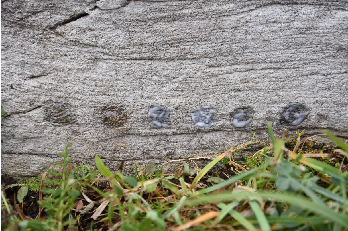
Figur 14 Test av løsemiddelgelene på berget. Ingen av testområdene viste en optisk forandring av steinen, Da 62015_14. Gelene virket på steinen i en halv time før de ble etter-renset med passende løsemiddel
