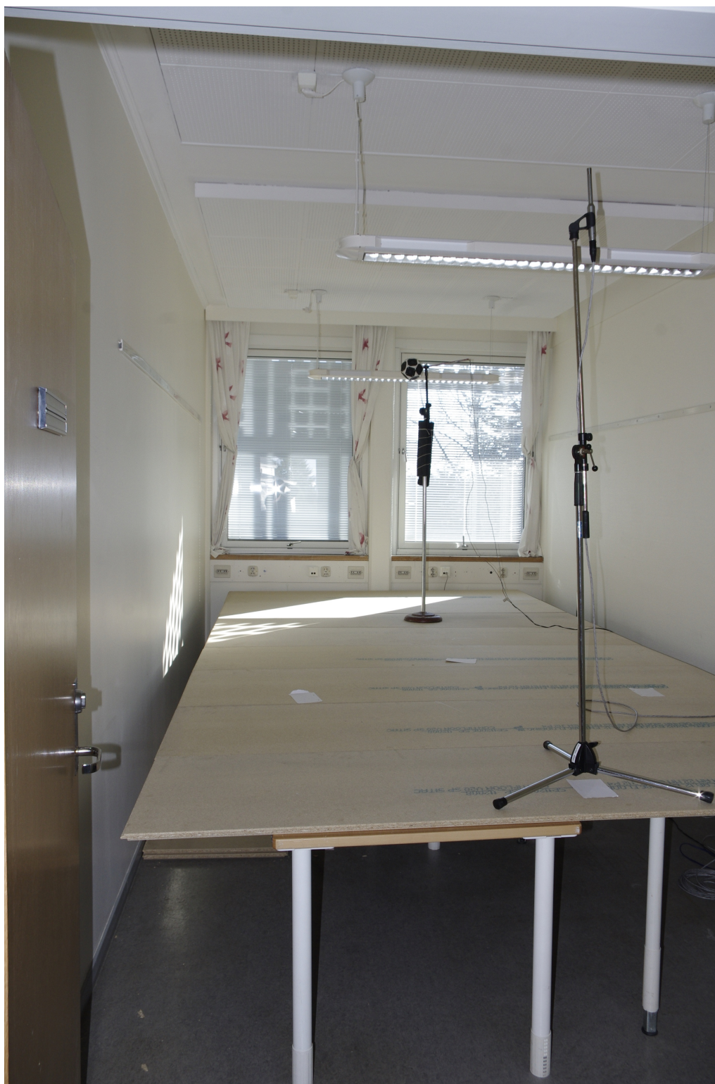
Figur 4.4: Testmåling med mikrofon og høyttaler på størst A og høyest h (modell snudd opp ned). Det er ikke denne mikrofonen som ble brukt i de virkelige målingene. Lysarmaturen ble også skrudd ned, og bordene ble byttet ut med et stilas.
