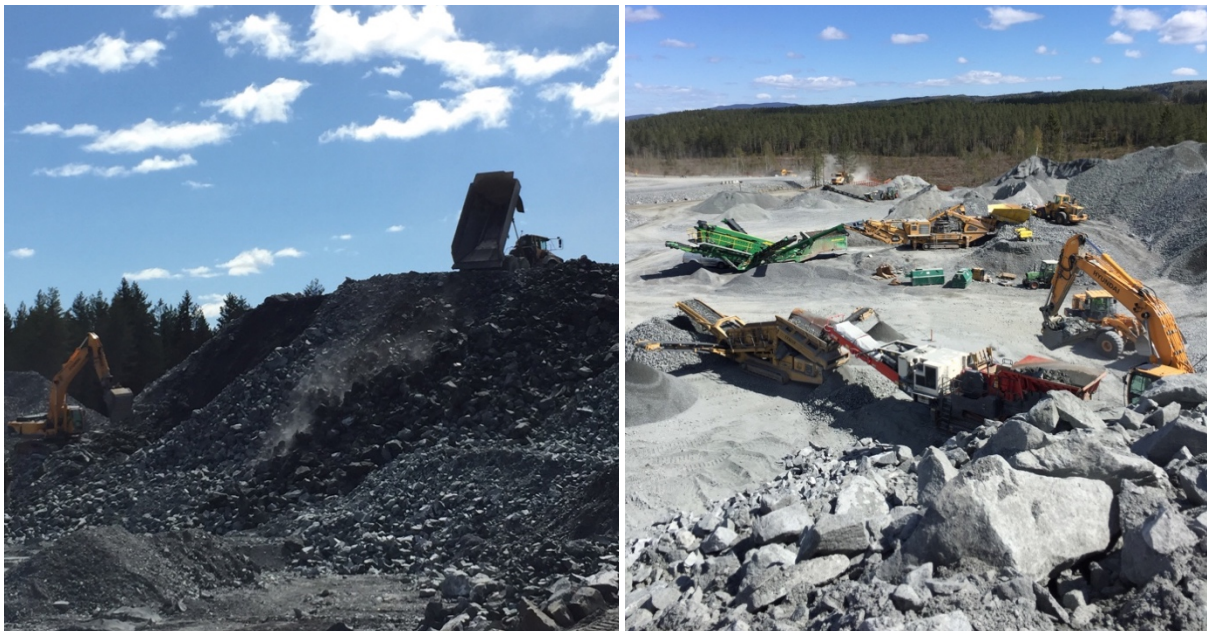
Figur 6.3: Tipping og knuseverk i samme området. Venstre bilde: Viser tipping nedover steintipp, med gravemaskin til venstre som laster inn i knuseverket. Høyre bilde: Utsikten over knuseverket fra oppå tippen.
