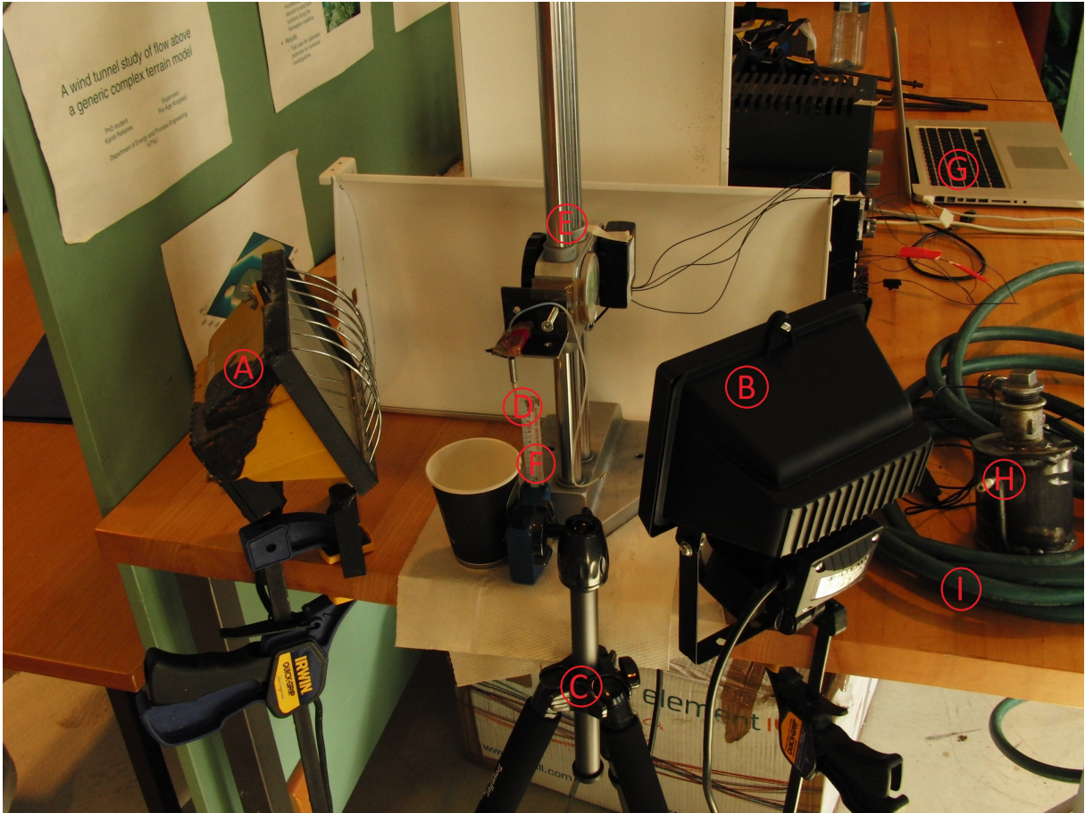
Figur 3.5: A og B : Halogenlamper 500W. C : Kamerastativ. D : Dyse. E : Justerbart stativ for dyse. F : Målebånd. G : Laptop m/ DAQ-enhet. H : Væskekammer. I : Slange for trykkluft.
