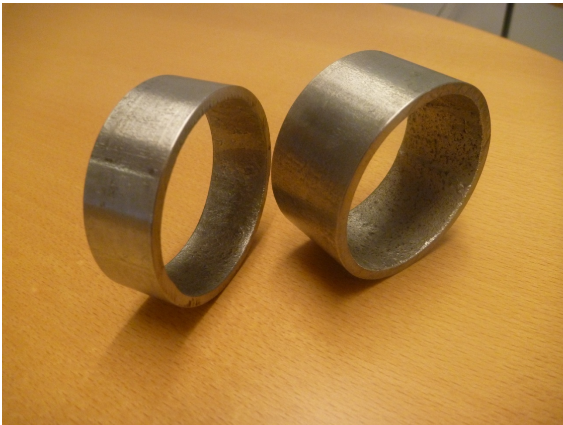
Bilde 2; «Fryselement» av stålrør
