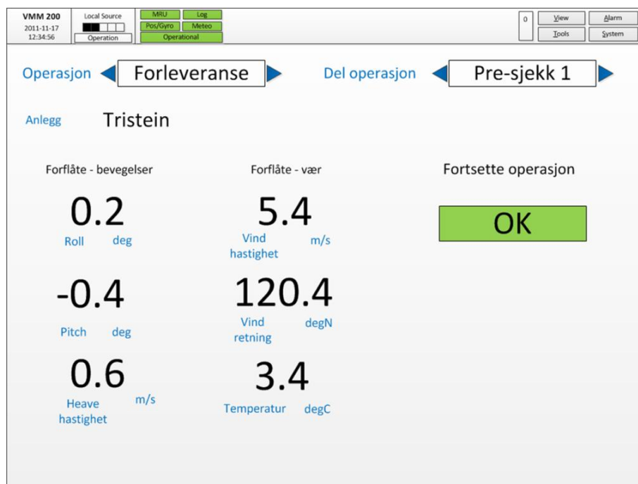
Figur 12b. Eksempel på brukergrensesnitt for presjekk 1. I dette VMM skjermbildet på brua på fôr båten, vises fôrflåtens bevegelser og værd data som er innenfor tillatte verdier for operasjon. Derfor kommer grønt OK indikator opp på skjermen og seilasen inn mot anlegget kan fortsette.
