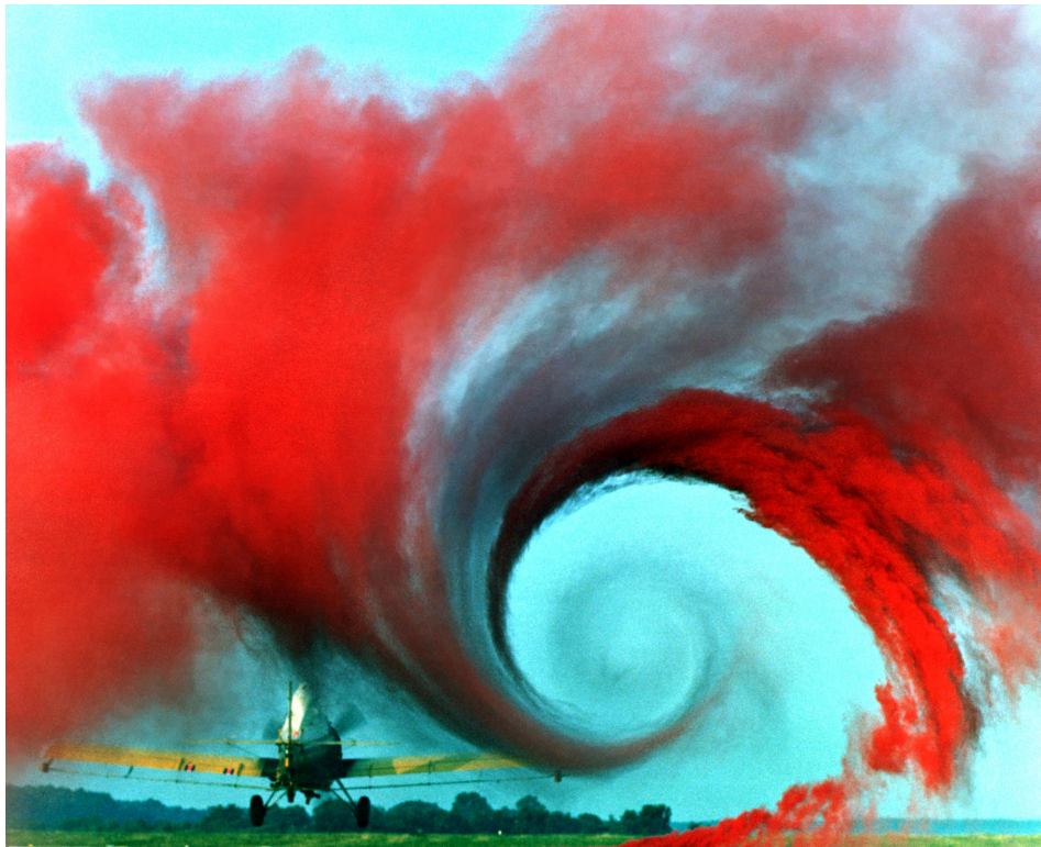
Figur 1.2: En strømvirvel ved enden av en flyvinge. Bilde hentet fra NASA bildearkiv [4]
