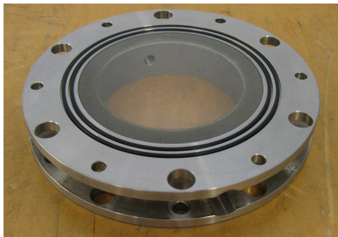
Figur 9: Prøveholder med påstøpt polymerfilm
