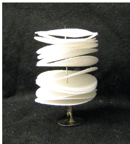
Figur 12: Svellebandprøver tredd på metallnål for karakterisering
