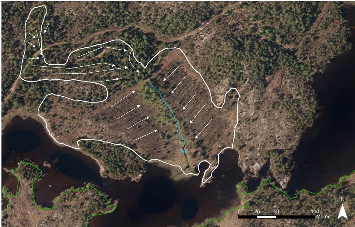
Figur 27. Myr 9 i Nyvassdalen, Hildremvatnet naturreservat. Dreneringsretning i grøfter er angitt med hvite piler, og naturlig dreneringsretning med blå piler. Grønn linje angir tidligere reservatgrense. Ortofoto fra 2012. Kilde: Norge i bilder.
