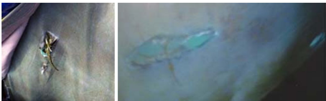
Figur 7: Hull i skjørtet observert med undervannskamera (høyre) og ved skjørtopptak (venstre).
