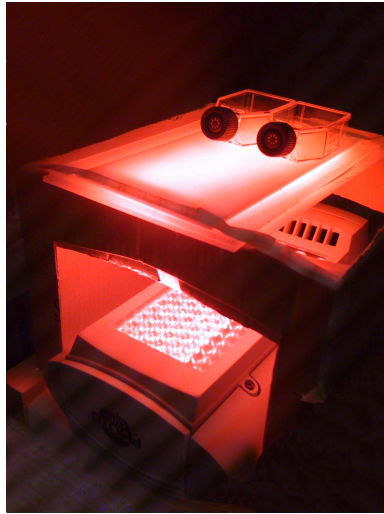
Figur 5.4: Oppsett under lysforsøk. Flaskene med cellene er plassert på en glassplate over lyskilden. Lyskilden har en emisjonstopp på 631-632 nm og lysstyrken på oversiden av glassplaten er i gjennomsnitt på 20 mW/cm 2 .
