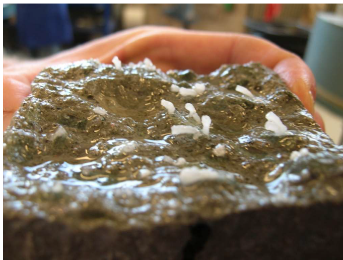
Figur 5.5: Reaksjonsprodukt fra ASR [26]
