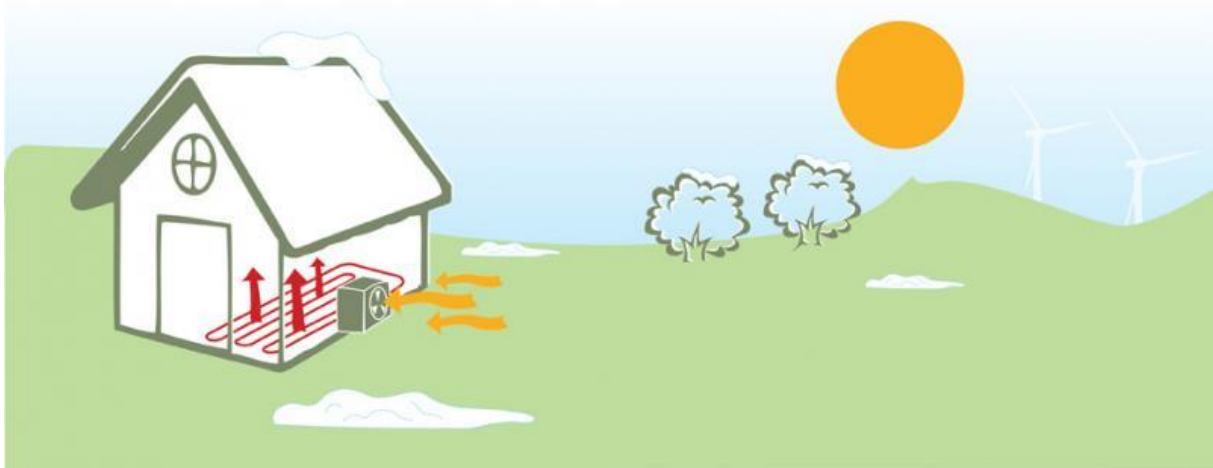
Illustrasjon 7- Varmepumpe skaffer varme til vannbåren gulvvarme (Norsk Varmepumpeforening u.d.).
