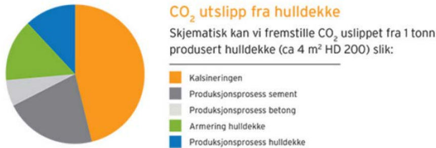
Figur 47: CO 2 utslipp fra hulldekke (Spenncon)
