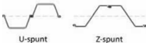
Figur 7: Vanlige spunkprofiler (Statens vegvesen)
