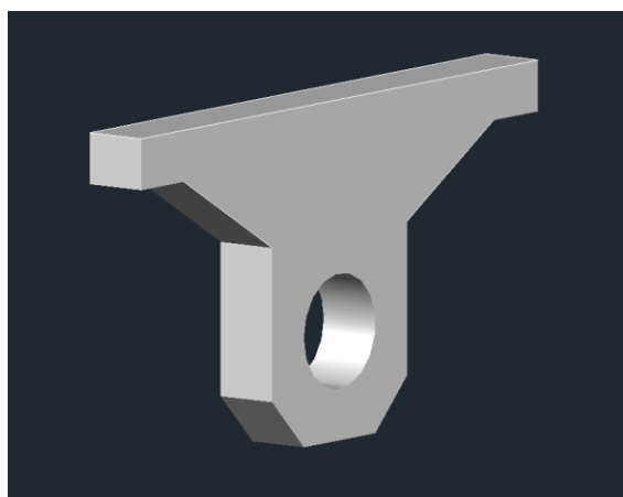
Figur 3.1.7-3- Festarm sveiset til underkant av fagverk
