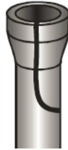
Figur 4-19: Bell splitting i gråstøpejern ledning
