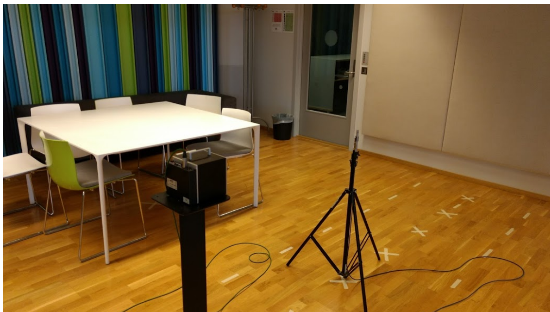
Figur 3.9: Impulsresponsmåling i rommets lengderetning.
