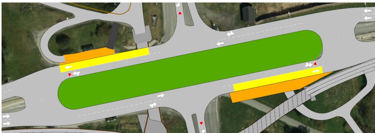
Figur 7.27: Konsept 2.1.2 - Avlang rundkjøring - Høyreregel - Grønnåsenkrysset ovenfra
