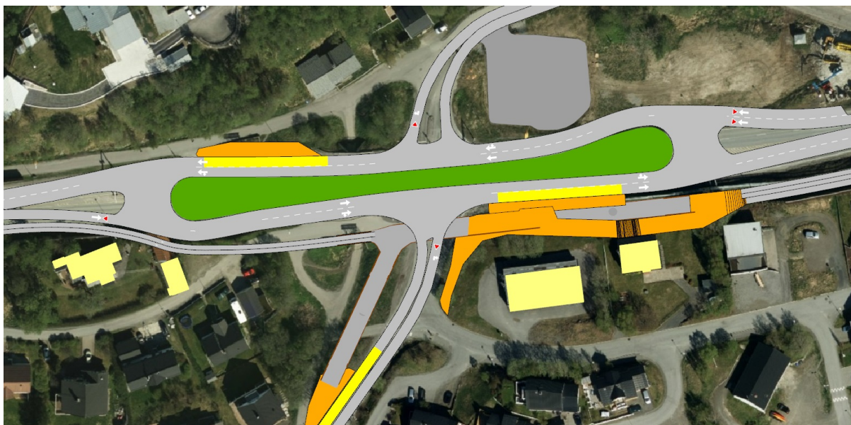
Figur 7.25: Konsept 2.1.1 - Avlang rundkjøring - Stille Dal krysset ovenfra
