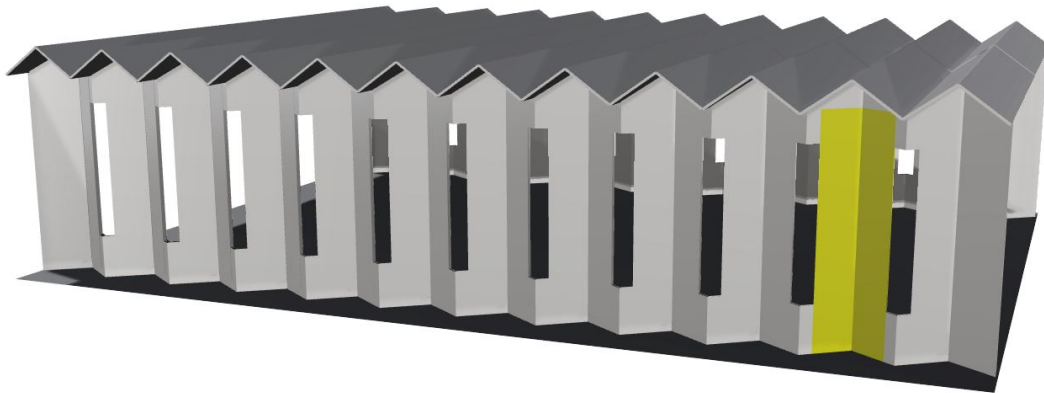
Figur 8.2: Skissert modell av hovedkonstruksjonen til kirken. Det repeterende foldede veggelementet er markert i gult.
