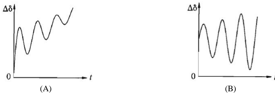
FIGUR 3.1 USTABILITET I IKKE-OSCILLERENDE MODUS (A) OG I OSCILLERENDE MODUS (B).[15]
