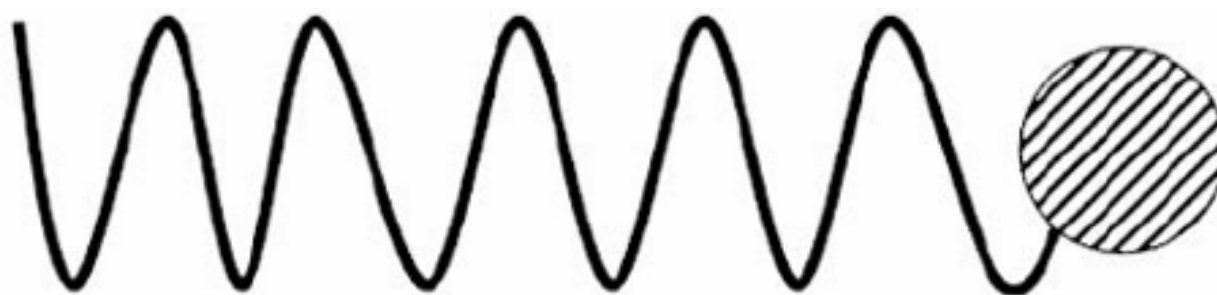
Figur 2.7: Figuren illustrerer et tensid med en hydrofil "hodegruppe" (sirkel) og en lang hydrofob hale. Figuren er hentet fra Kronberg et al. (2014), side 2, kap 1.
