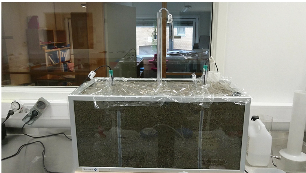
Figur 3.6: Figuren viser det ferdige oppsettet av sandboksen. Tre lysimetre står opp av sanden, mens det er en brønn i hvert hjørne på høyre side. To timere kan sees til venstre i bildet.
