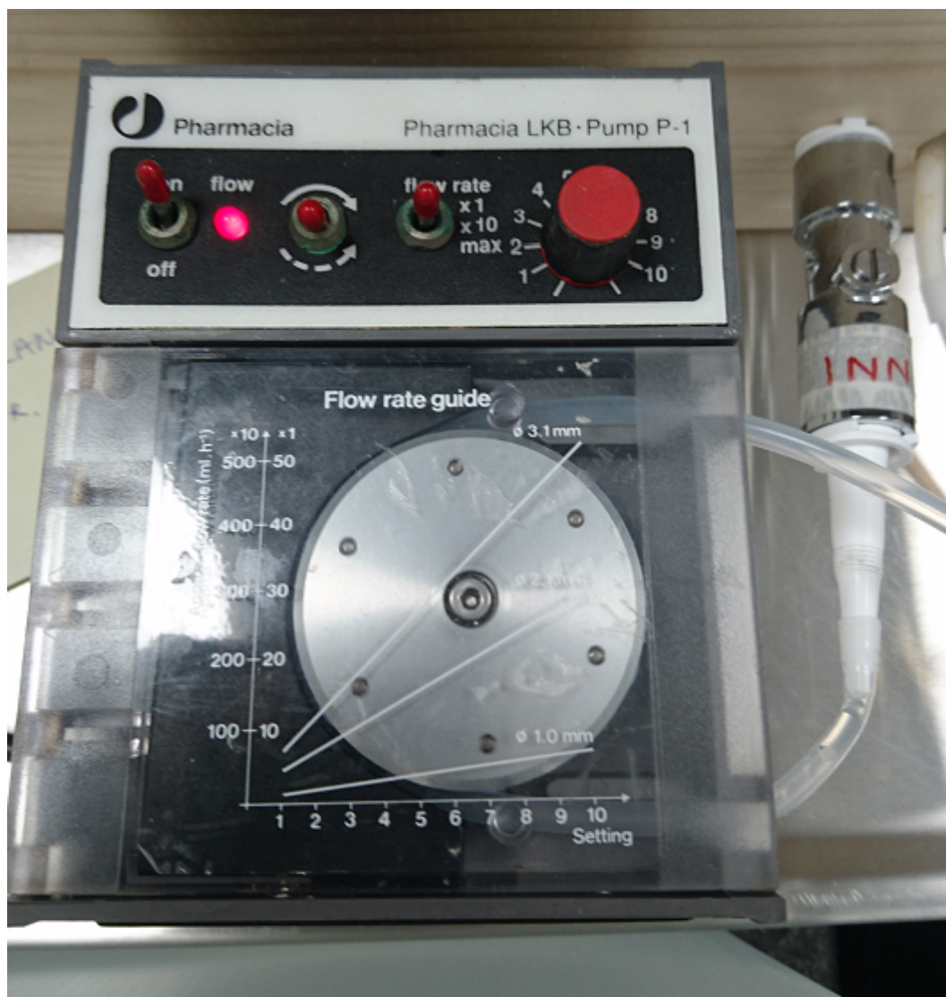
Figur A.3: Figuren viser en peristaltisk pumpe av typen Pharmacia LKB Pump P-1. Denne pumpen er koblet til "INN"-dysen.
