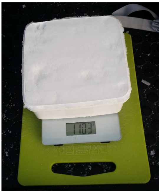
Figur 20: Testvekt fra kl.09.51, 1103g tilsvarer kvalitet 6, og det ble produsert med 3 ringer.
