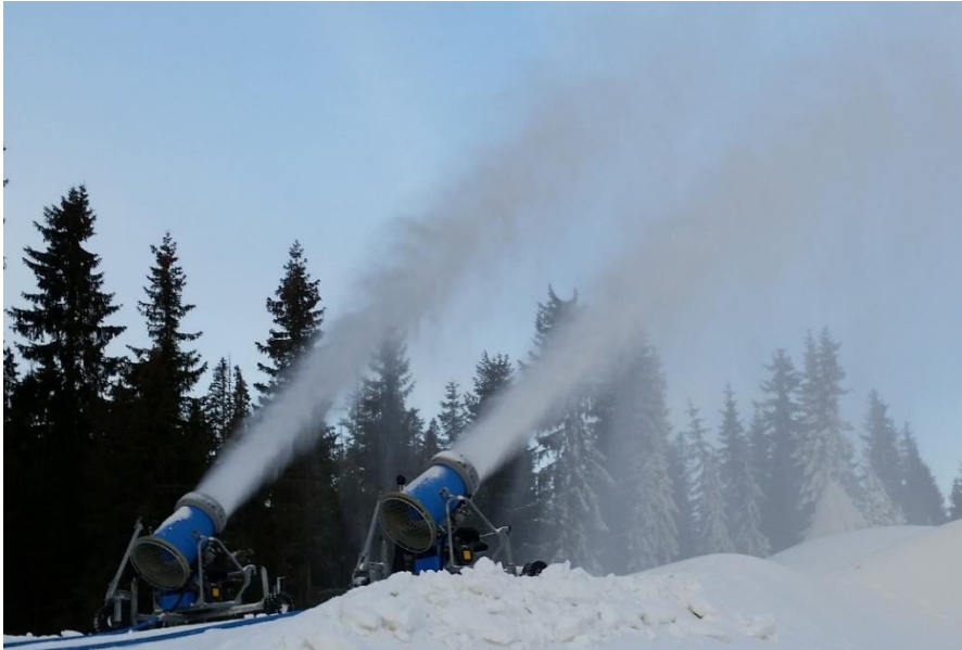
Figur 6: Eksempel på viftekanon. Lenko Northwind, under produksjon i Granåsen
