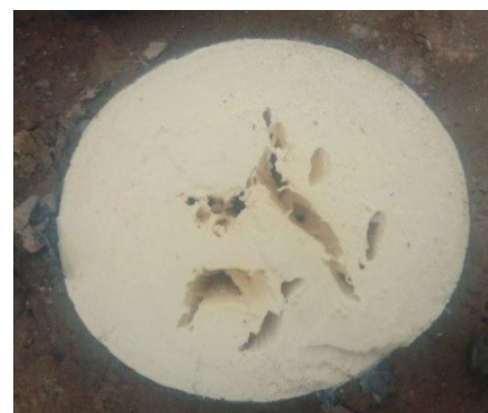
Figur 2 Hulrommene indikerer høy varmeutvikling
