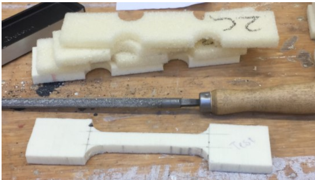
Figur 52 Utskjæring av prøvestykker
