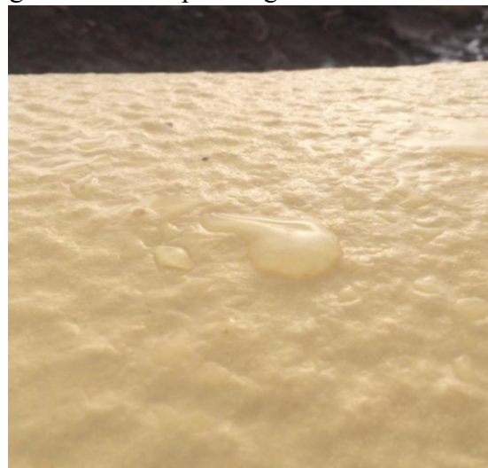
Figur 29 Overflate med "hinne" som beskytter vannet mot å trenge inn
