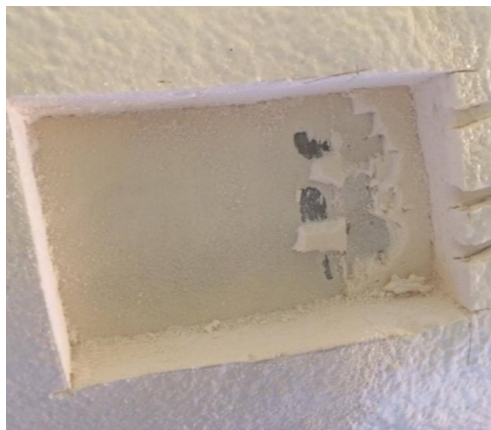
Figur 28 God heft mellom PU-skum og røroverflaten
