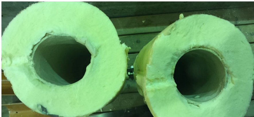
Figur 1 Prinsippfigur av PU-skum som omfyllingsmasse (Aaker, 2017)
