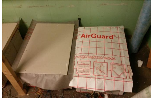
Figur 32a og b. Boksene blir forseglet med butylbånd rundt randen av boksen (a), før dampspærren monteres over åpningen (b).
