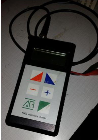
Figur 47. FME Moisture Meter benyttet til å måle fuktinnhold i trematerialene.
