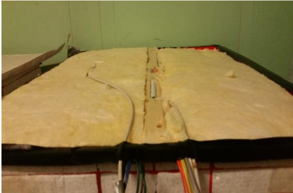
Figur 32a og b. Boksene blir forseglet med butylbånd rundt randen av boksen (a), før dampspærren monteres over åpningen (b).
