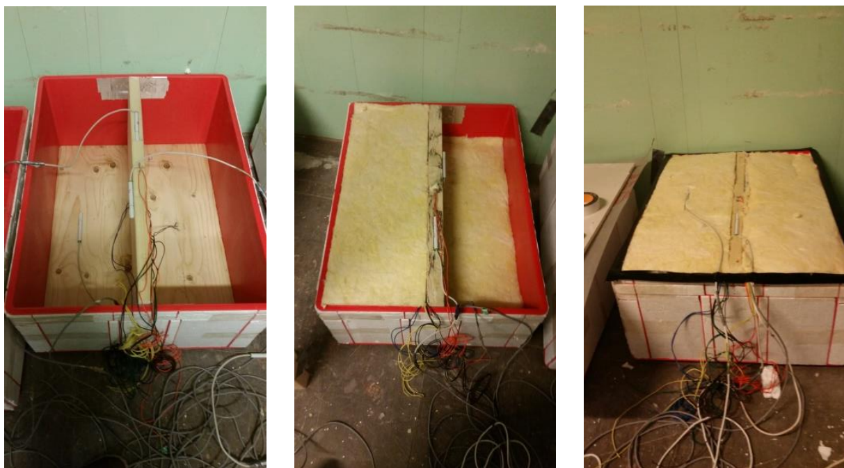
a. b. c. Figur 31 a, b, og c. Oppbyggingsprosessen av prøveboksene. Treverk monteres først (a), deretter måleinstrumentene før isolasjon monteres til slutt (b og c).
