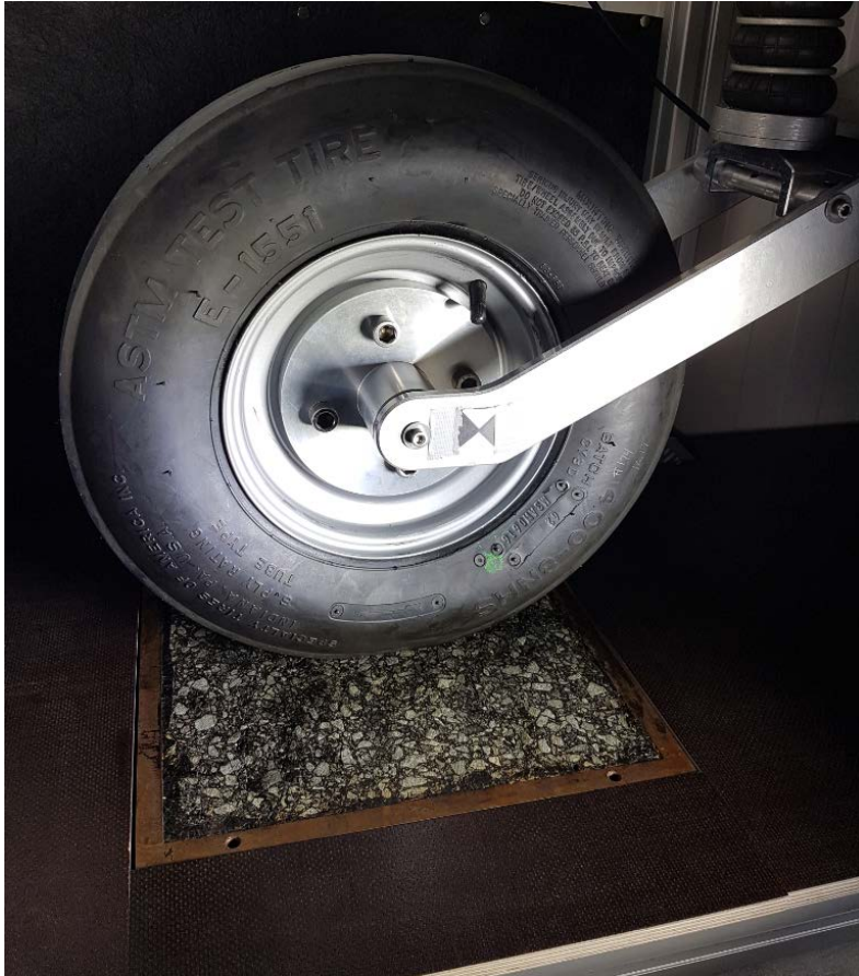
Bilde 3-1: Dekk og asfaltplate på friksjonsbane
