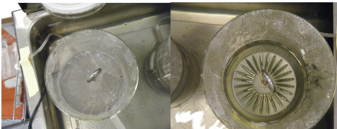
Figur 35: Minireaktor for dyrking av biofilm sett ovenfra. Til venstre sees minireaktor med dyrking av P. aeruginosa PAO1 gfp, 69 timer. Til høyre sees minireaktorer med dyrking av P. aeruginosa PA14 gfp, 48 timer.
