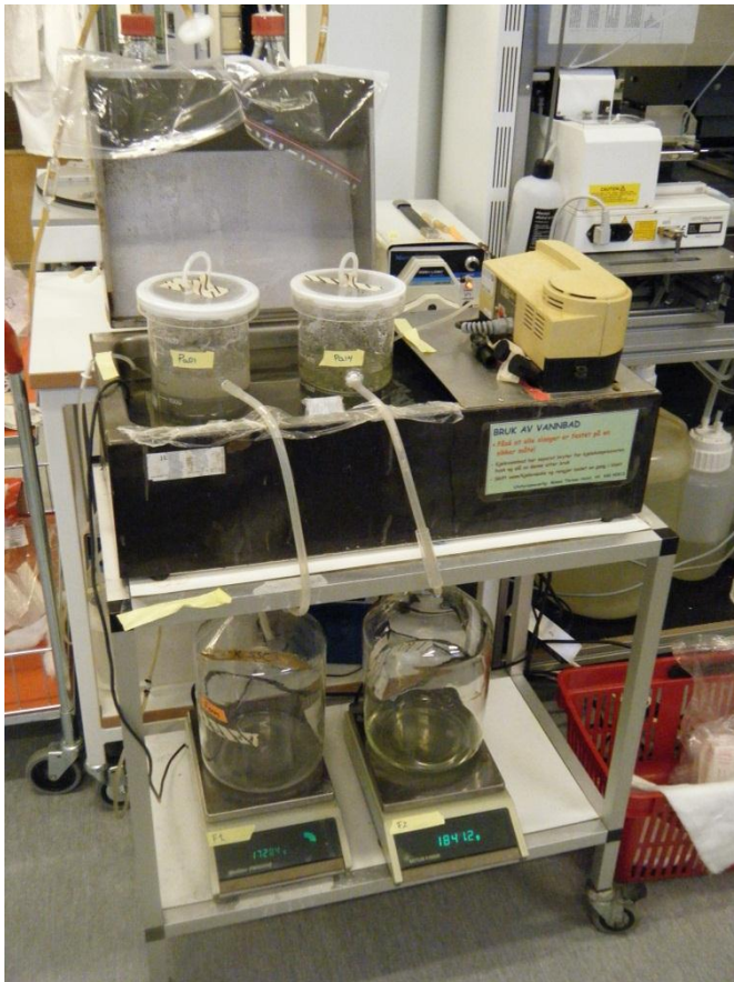
Figur 7: Oppsett for dyrking av biofilm i minireaktor. To minireaktorer, for dyrking av henholdsvis P. aeruginosa PAO1 og P. aeruginosa , plassert i vannbad (37 °C).
