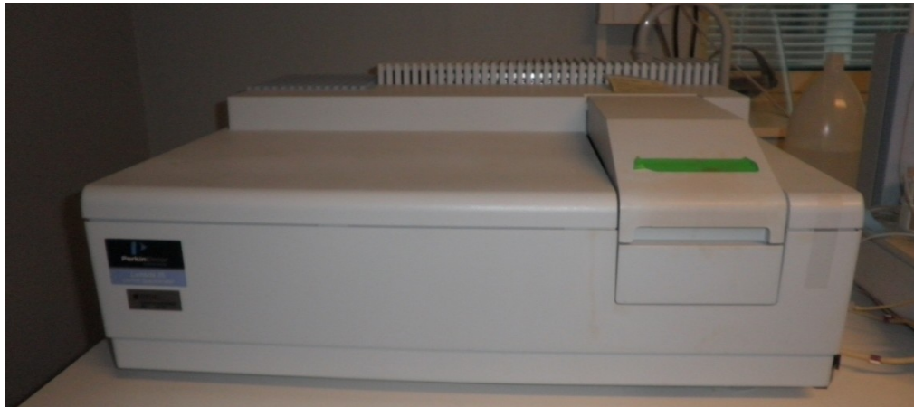
Figur 2.3: Spektrometeret absorbansmålingene ble utført i, Perkin Elmer lambda 25 UV/VIS spektrometer(Perkin Elmer Inc., USA).
