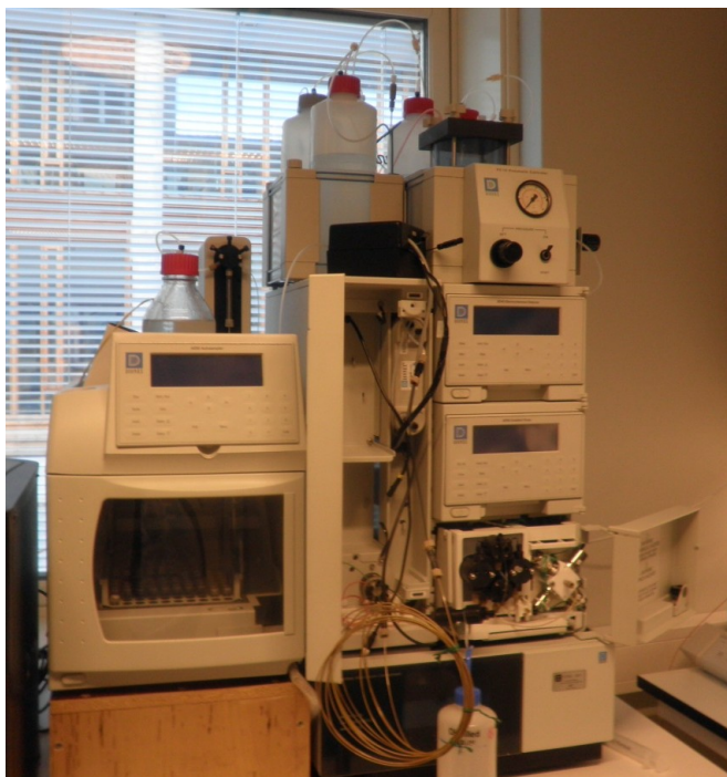
Figur 2.2: HPAEC-PAD, Dionex BioLC System (Dionex Corp, Sunnyvale, CA).
