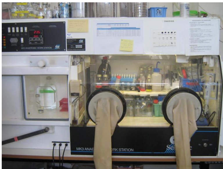
Figur 7: Anaerob arbeidsbenk benyttet for å sette opp forsøk med anaerobe vekstvilkår. Utstyr som var nødvendig til forsøket ble sluset inn i benken ved hjelp av et kammer som ses til venstre i bildet.
