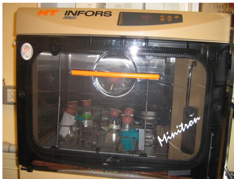
Figur 4: Minitron risteskap (Infors AG, Bottmingen, Sveits) benyttet til inkubering av bakteriekulturer.
