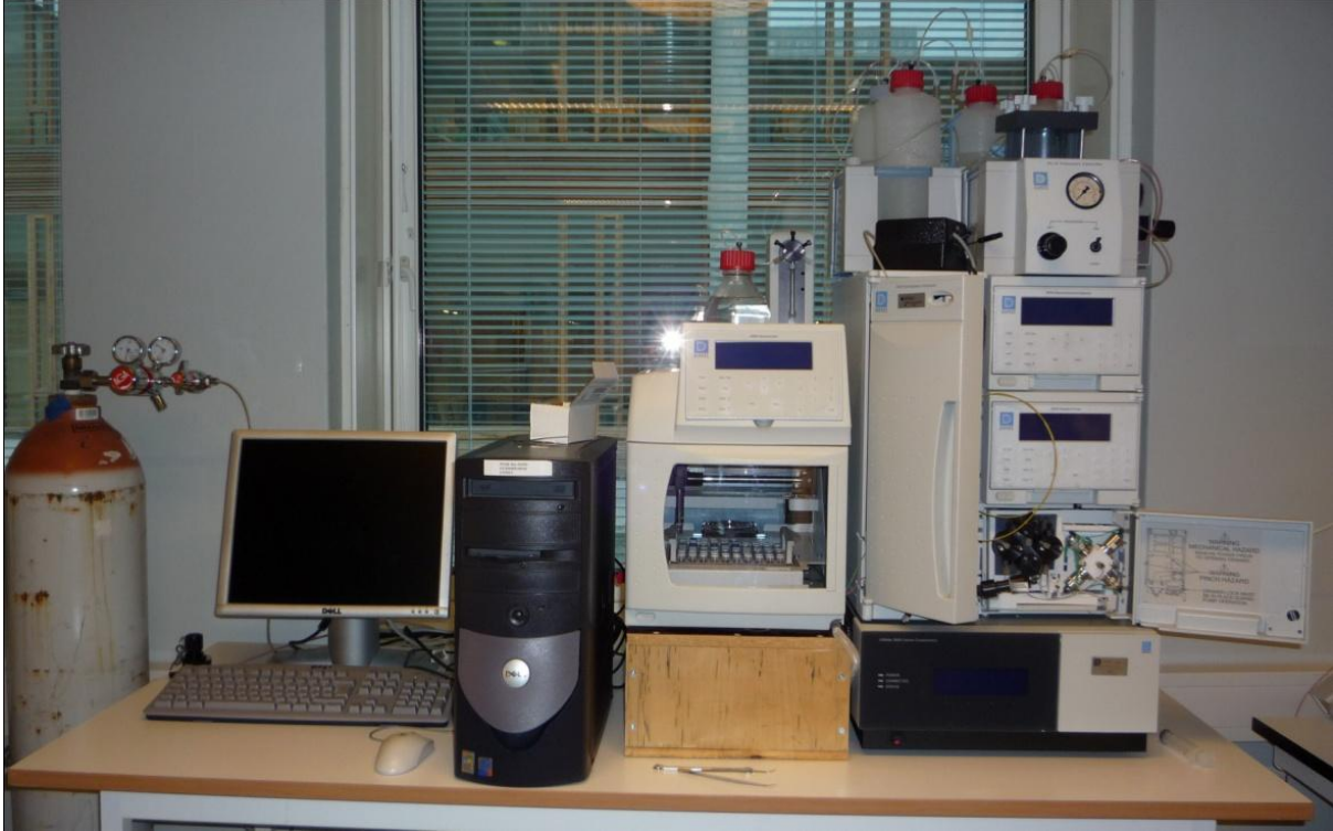
Figur 2.5: HPAEC-PAD-instrument benyttet for analyse av oligomersammensetning.
