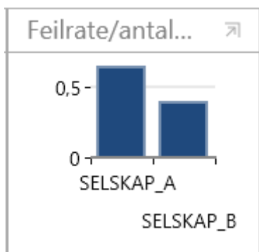
Figur 40: Sammenligning av feilrate for 11-22kV kraftledning der utløsende årsak er "fugl/dyr" i perioden 2009-2016. Selskap A er Trønderenergi, mens selskap B er Helgeland Kraft.
