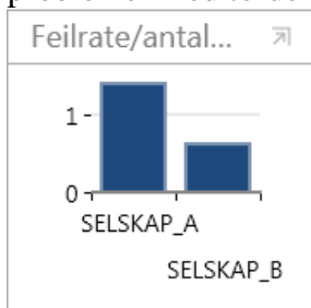
Figur 73: Sammenligning av feilrate for 11-22kV kraftledning der utløsende årsak er "tordenvær" i perioden 2009-2016. Selskap A er Sunnfjord Energi, mens selskap B er SFE Nett.
