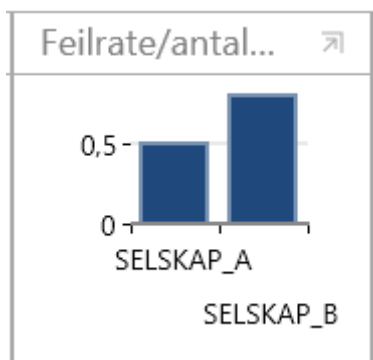
Figur 44: Sammenligning av feilrate for 11-22kV kraftledning der utløsende årsak er "tordenvær" i perioden 2009-2016. Selskap A er Trønderenergi, mens selskap B er Helgeland Kraft.
