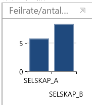
Figur 23: Sammenligning av feilrate for perioden 2009-2016. (Y-akse: antall feil/100km)
