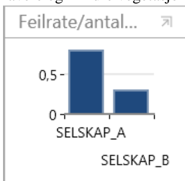
Figur 32: Sammenligning av feilrate for 11-22kV kraftledning der utløsende årsak er "vegetasjon" i perioden 2009-2016. Selskap A er Trønderenergi, mens selskap B er Helgeland Kraft.
