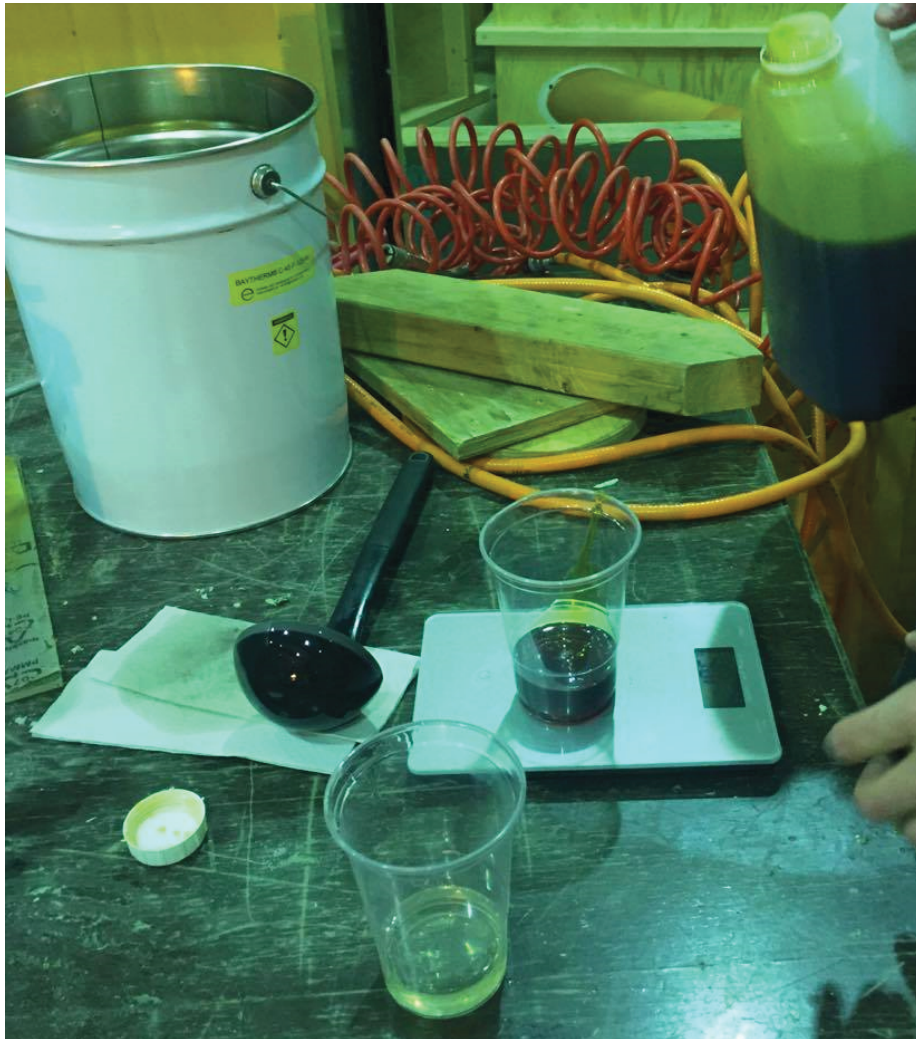
Figur 34: Oppveiing av isocyanate (brun væske) og polyol (lys væske)
