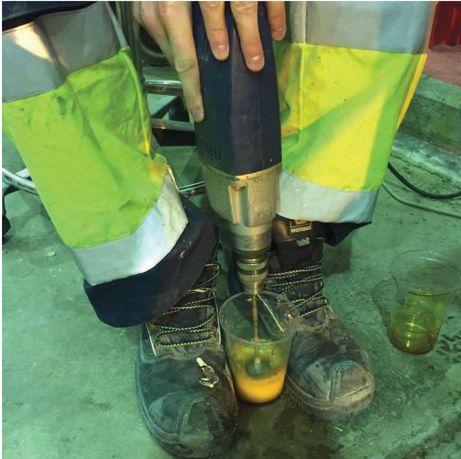
Figur 35: Blanding av skum til forsøk. Til høyre i bildet er koppen med gjenværende isocyanate
