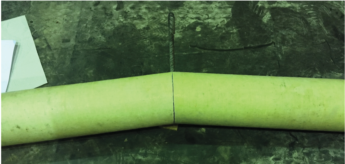
Figur 38: GRP-rør som ble benyttet i forsøkene, kuttet i 15 °
