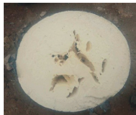
Figur 2 Hulrommene indikerer høy varmeutvikling
