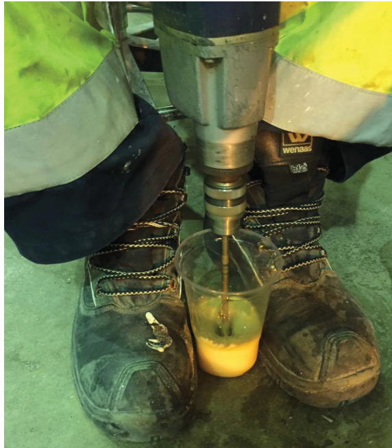
Figur 15: Blanding av PU-skum med håndmiksing i laboratorium
