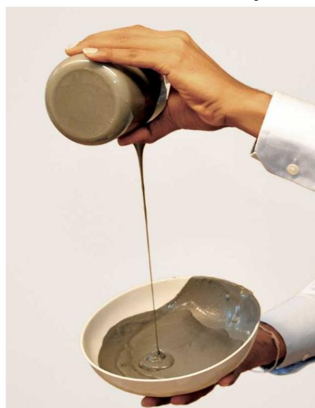
Figur 35: Overbelastning av kvikkleire danner en suppe (SINTEF Byggforsk, 2014).
