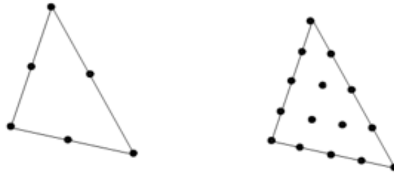
Figur 36: Triangulære elementer med 6 eller 15 knutepunkter (Nordal, 2016).
