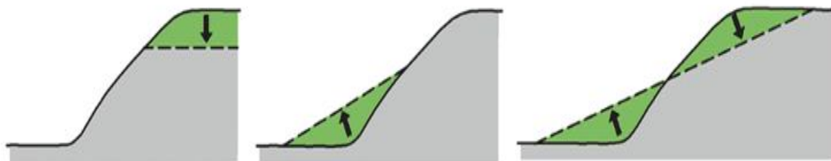
Figur 29: Tiltak som forbedrer skråningsstabiliteten (SINTEF Byggforsk, 2014).
