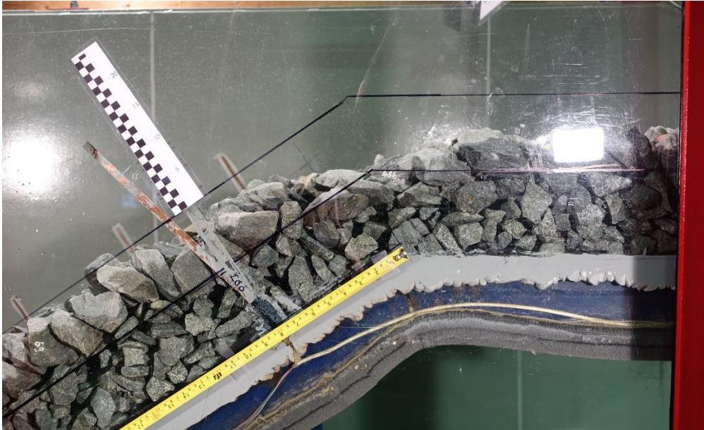
Figur 2-3 - Forskyvninger etter vannføring 100 l/s/m
