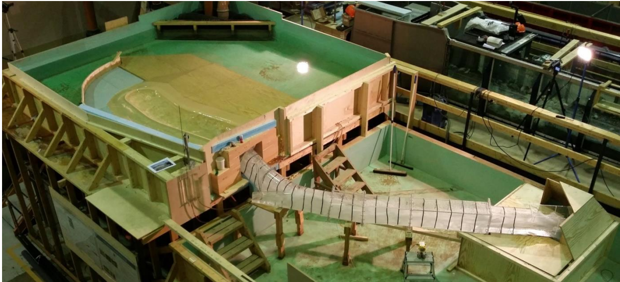
Figur 4-1 Bygget modell, geometrisk lik prototypen (Foto: Gunnar Fiskum)
