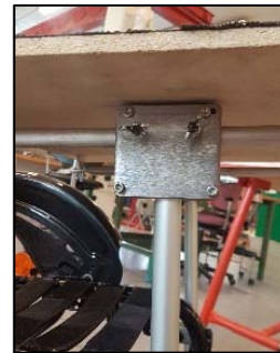
Figur 23 - Forskyvningsledd påmontert med justering
