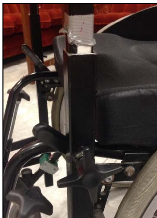
Figur 4 - Bordjustering i det vertikale planet (Dybendal, 2017)
