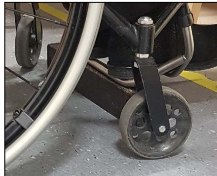
Figur 13 - Støttekloss under fothvilerne
