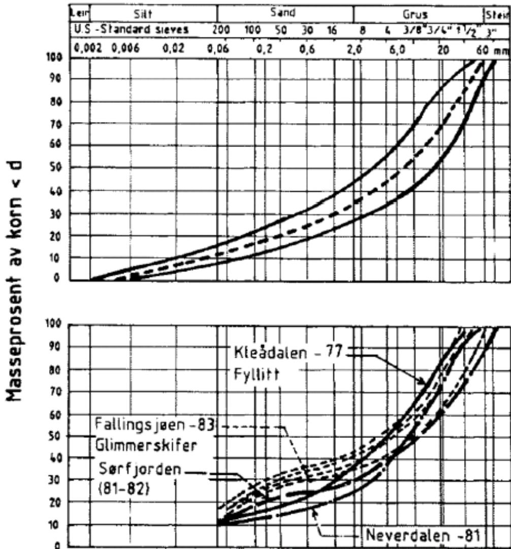
Figur 9 Kornfordelingskurver fra norske TBM-tunneler (Statkraft/NGI)
