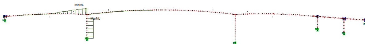
Figur 6-9: Momentdiagram lasttilfelle med tvangskrefter fra spennkabel 126 og 226
