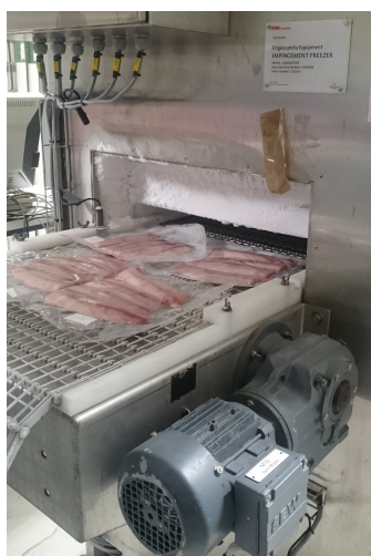
Figur 2.4: Skallfrysing av vakuumpakkede makrellfileter før superkjølt lagring ble gjort i 90 sekunder ved -37^{\circ}\text{C} .
