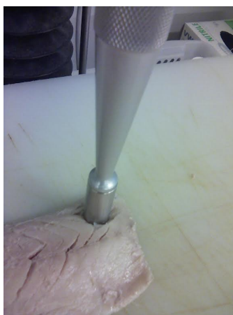
Figur 2.7: Teksturmåling av makrellfilet ved hjelp av en TA-XT2-teksturmåler, utstyrt med et lodd på 1 kg. Foto: Janna Cropotova
