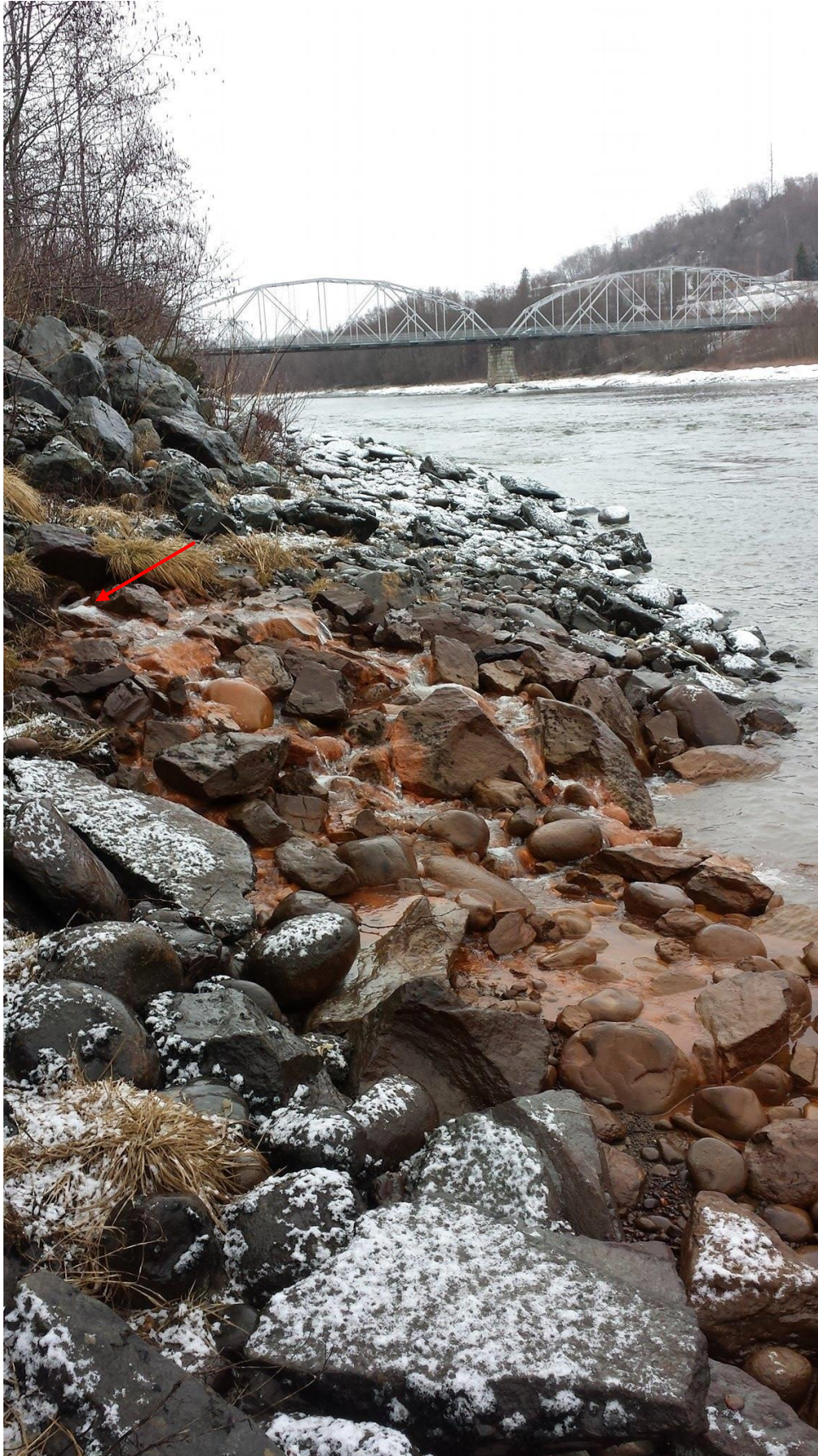
Figur 29: Returavløpet til anlegget på Gimse skole ved elva Gaula. Pilen markerer utløpet og hvor prøvene ble tatt.
