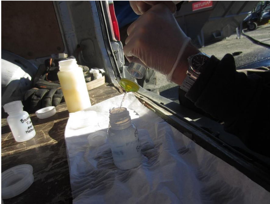
Figur 26: Filtrering av metallprøven med 0.45 \mu\text{m} filter.
