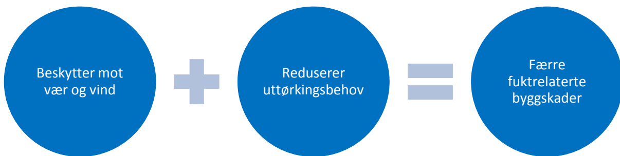
Figur 59: Bygging under telt sitt hovedbidrag ovenfor byggskafer.
