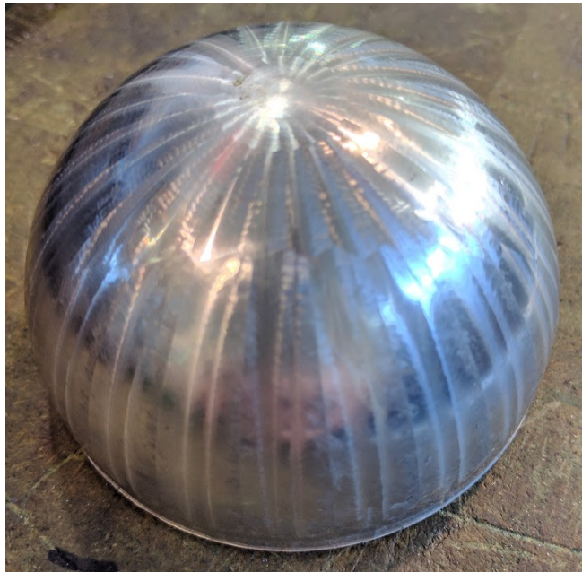
Figur 3.21: Halvkulen maskinert, med råmet saget av.
