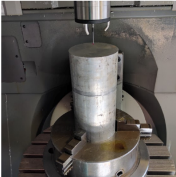
(a) Oppmåling av råemnet apent fast i kjoksen
