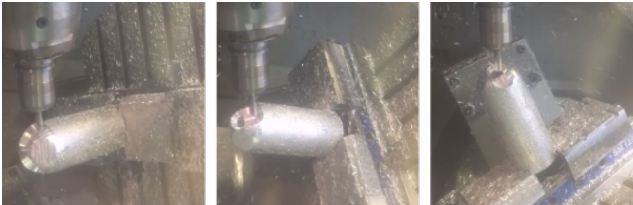
Figur 6.9: Fysisk fem-aksemaskinering med funksjonen Swarf
