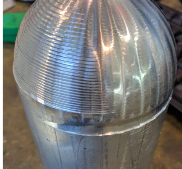
(b) Det kan observeres at nullpunktet er forskjøvet
