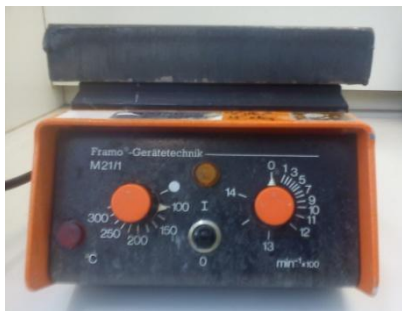
Figur 2.4: Varmeplate med en tykk stålplate på toppen. Konstruksjonen gav en jevnere temperatur enn varmeplaten alene. Foto: ASVF.
